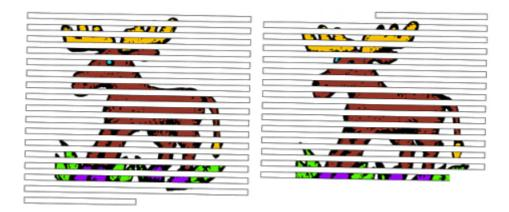
Beide Halbbilder bestehen aus 312,5 Zeilen, da das erste Halbbild mit einer halben Zeile in der Bildmitte am unteren Rand endet und das zweite Halbbild mit einer halben Zeile am oberen Rand beginnt.
