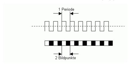
Jedem weißen Bildpunkt ist eine positive und jedem schwarzen Bildpunkt eine negative Halbwelle des Bildsignals zugeordnet. Eine Schwingung führt also zu einem weißen **und** einem schwarzen Punkt - und damit zu **zwei** Bildpunkten.
